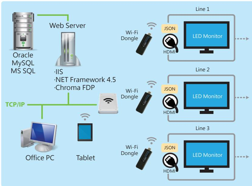
Chroma 新一代的電子看板管理解決方案，以 Android 平台裝置透過 HDMI 介面與各類型數位顯示器整合，在工廠環境下以 Wi-Fi 無線訊號快速傳遞各種資訊至顯示屏幕上，後台以 Web 介面的方式快速設定看板配置，可在工廠、醫院、賣場、公共環境等區域即時調整與上傳看板資訊，提供現場目視化管理解決方案的最佳選擇。
